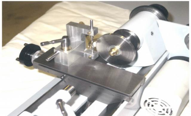
Dispositivo di rettifica dell'ancora del pendolo
